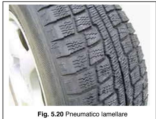
Fig. 5.20 Pneumatico lamellare
