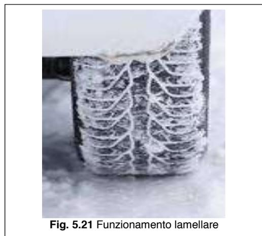
Fig. 5.21 Funzionamento lamellare
